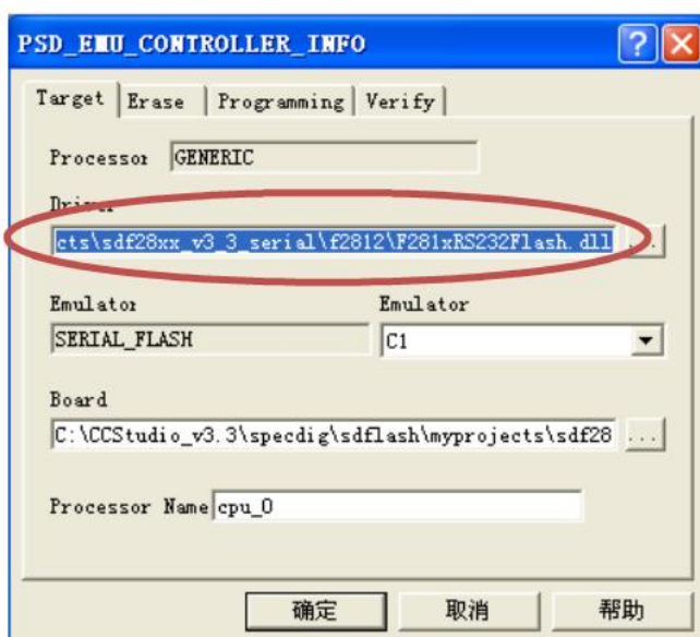
图3-4 修改F281xRS232Flash.dll路径
